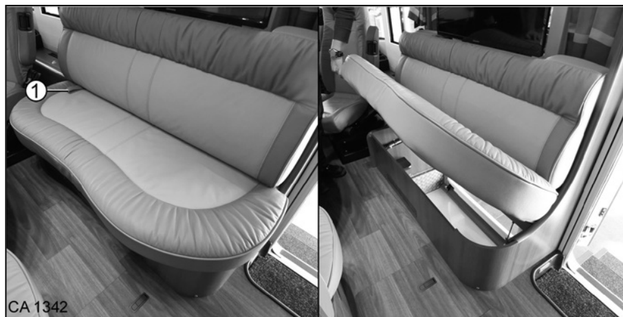
Afb. 72 Klapmechanisme lange zijzitbank
