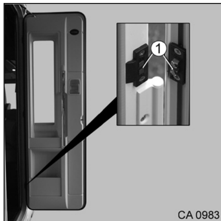
Afb. 44 Contacten voor centrale vergrendeling
