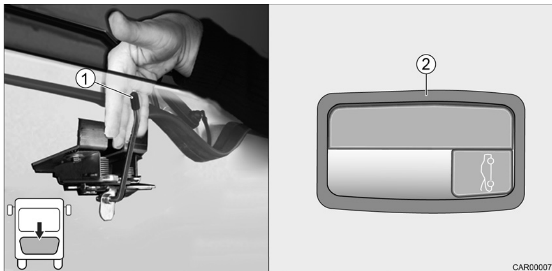
Afb. 13 Motorkap open maken
