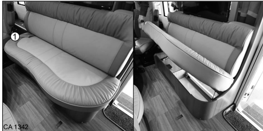
Afb. 65 Klapmechanisme lange zijzitbank
