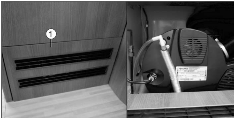
Afb. 120 Verwarming onder klerenkast
