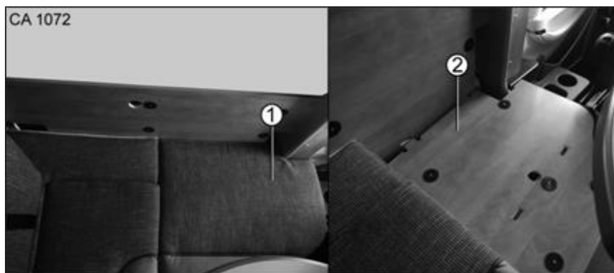
Afb. 20 Ombouw zitbank in de lengte tot zitplaats tijdens het rijden
