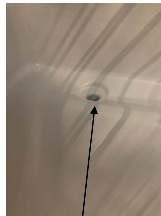
Trou d'évacuation vers le bac de récupération
