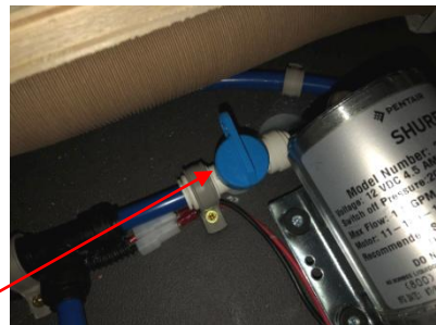
Vanne de vidange d'eau propre
