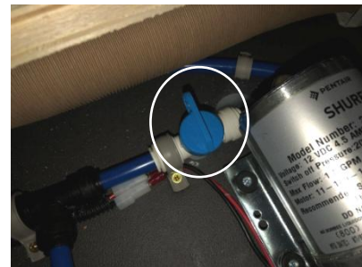
Vanne de vidange d'eau propre
