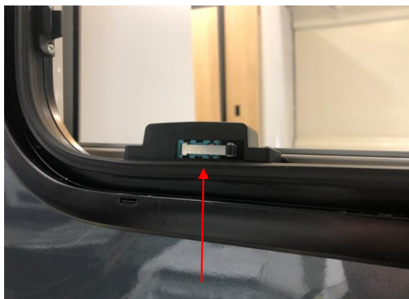
Contacteur de baie
