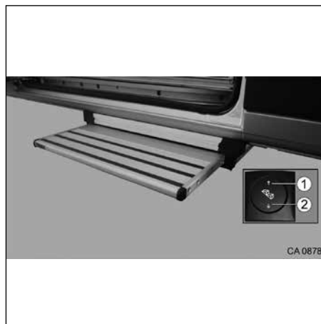
Afb. 1 Instaptrede met één opstap
